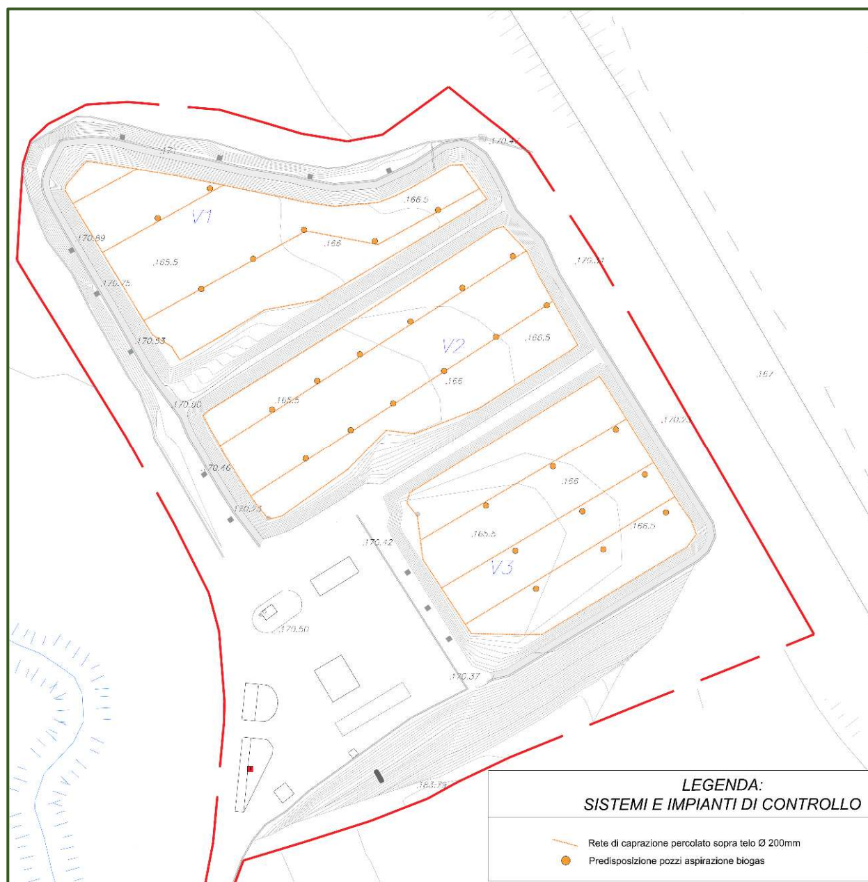
Figura 4.3/I: Planimetria della rete di drenaggio di fondo del percolato e dei pozzi di captazione del biogas
