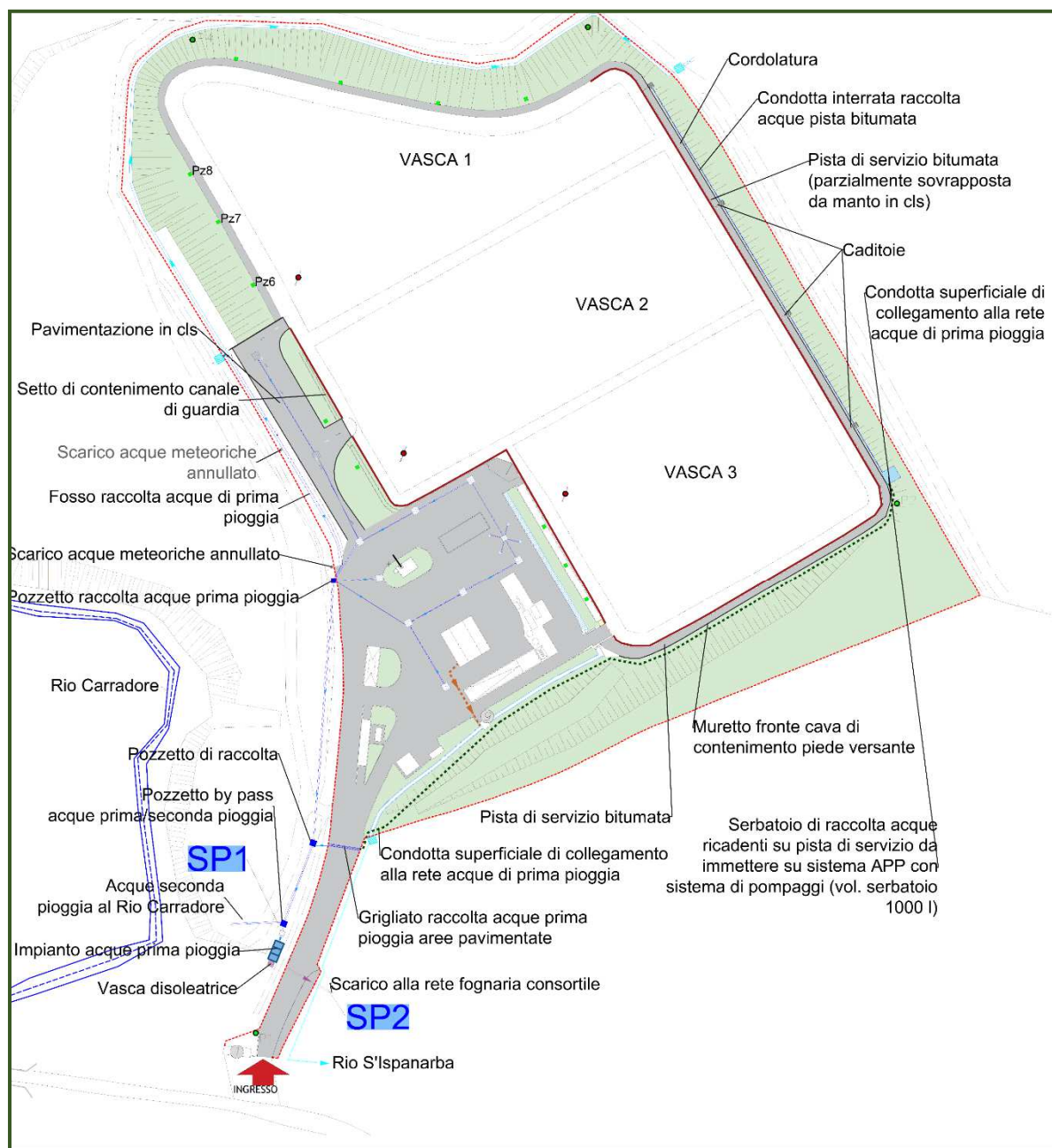
Figura 4.5/VI: Planimetria raccolta acque di prima pioggia ricadenti su aree pavimentate
