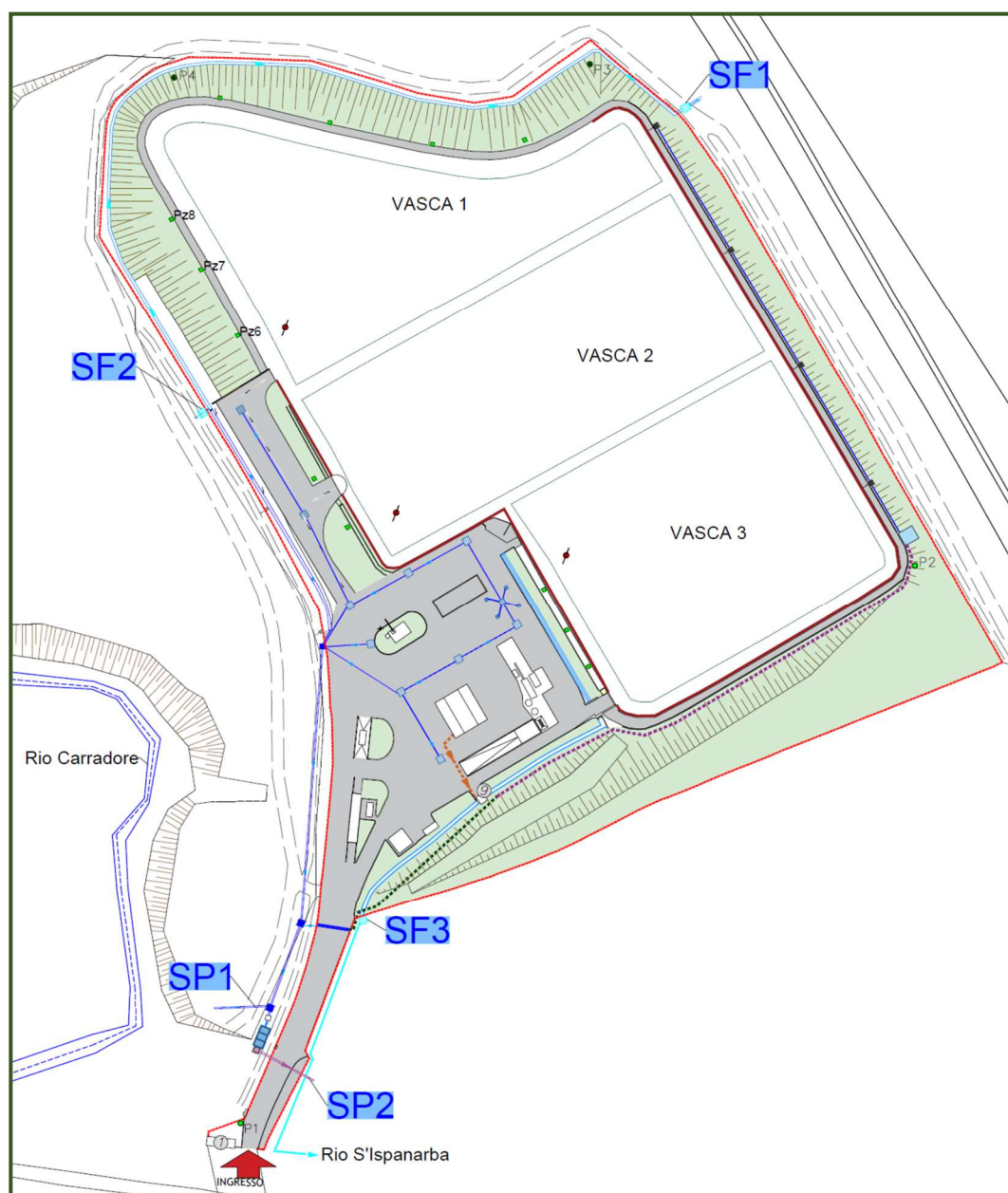
Figura 4.5/II: Individuazione punti di scarico acque meteoriche e acque di prima e seconda pioggia
