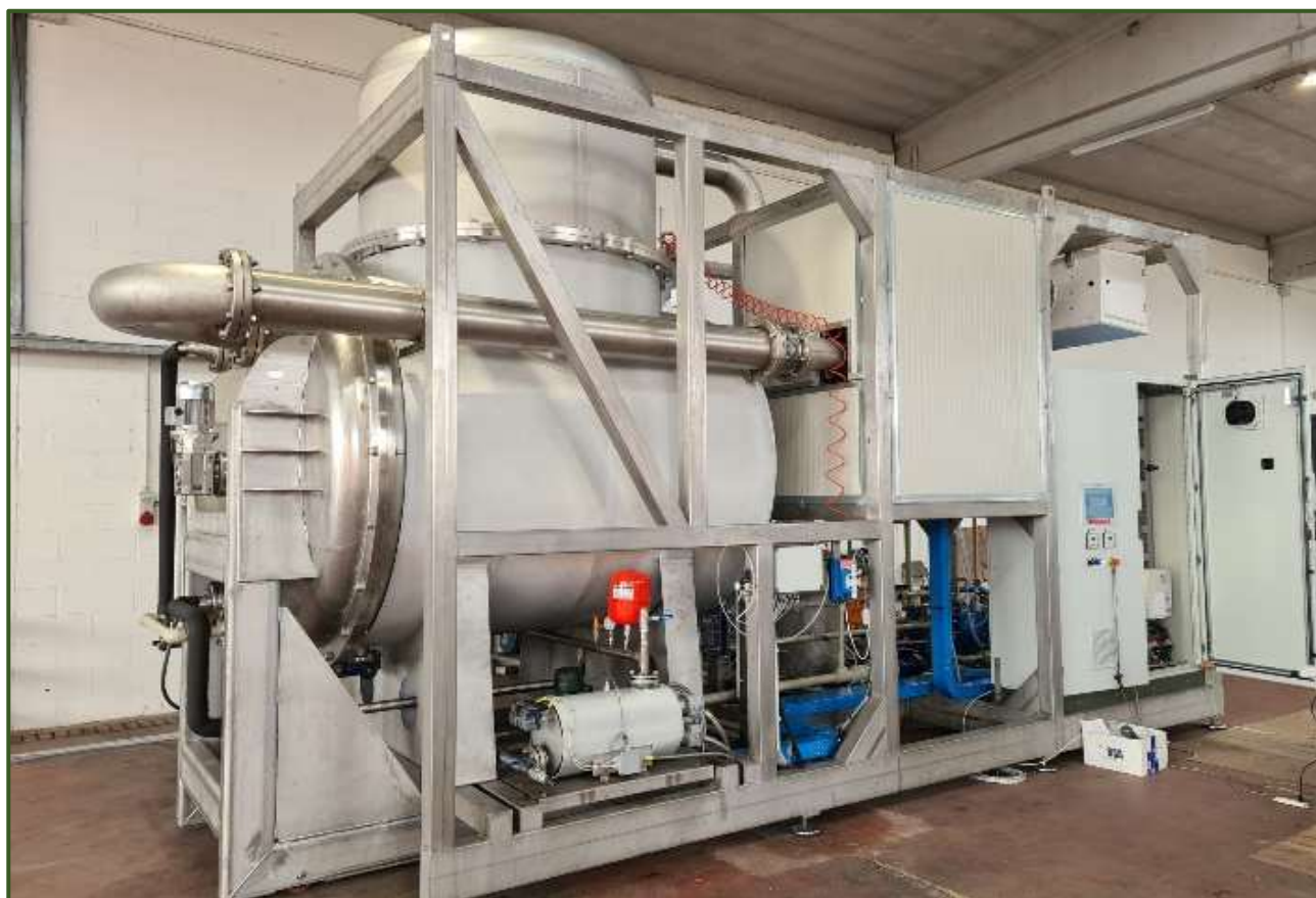
Figura 5.2/VI: Impianto evaporatore-concentratore
