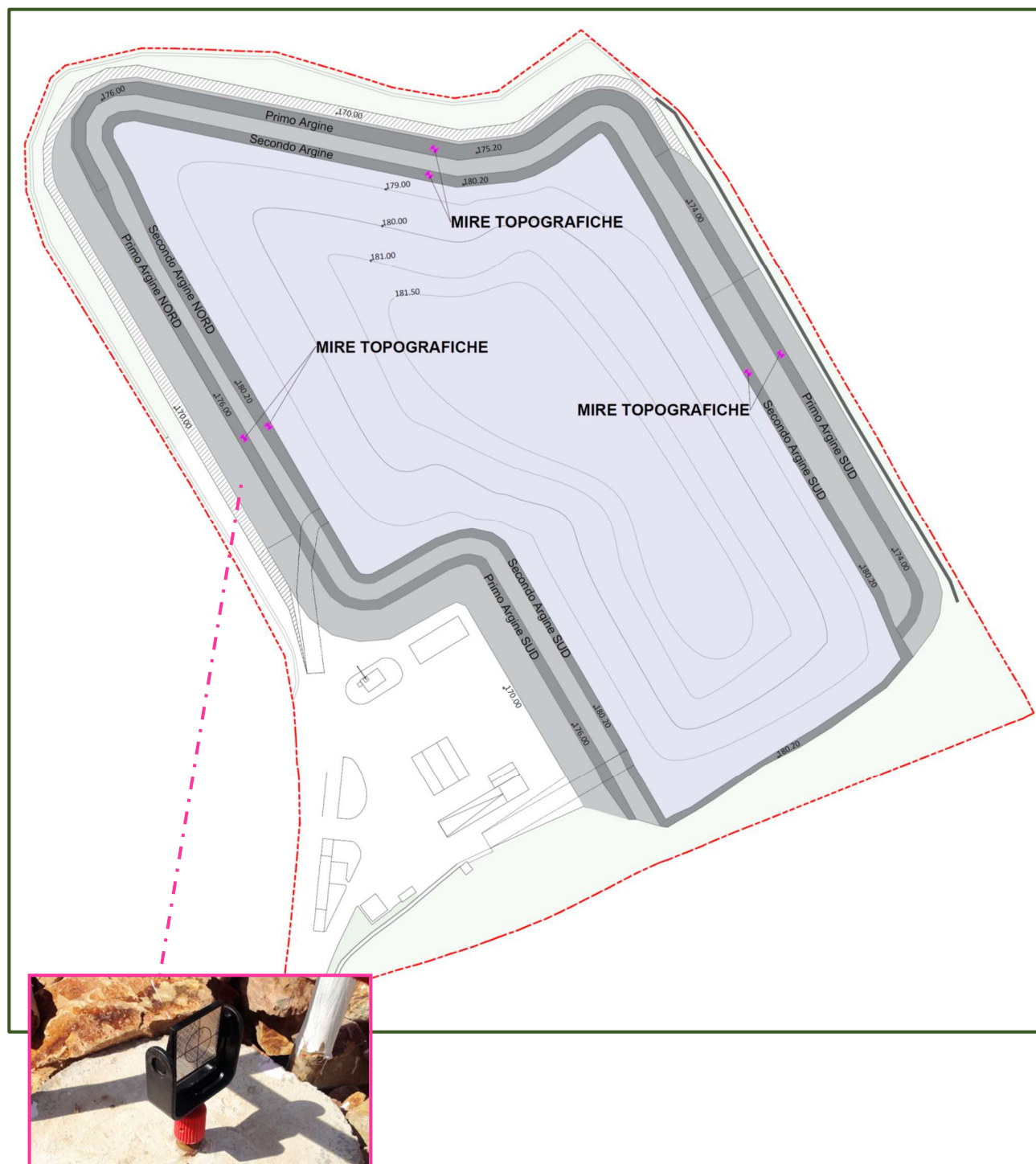
Figura 7.10/I: Indicazione di posizionamento mire topografiche
